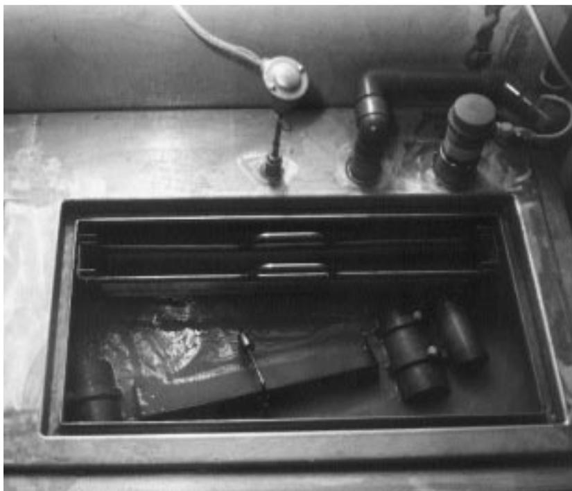
Entfettungsbad mit "selbstschwimmendem" Abschöpfgerät für den Ölaustrag
